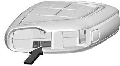
٢. افصل نصفي مفتاح التحكم عن بُعد باستخدام شفرة المفتاح الميكانيكي التي تم إدخالها في الجزء الأوسط السفلي من مفتاح التحكم عن بُعد. لا تستخدم شق المفتاح.
