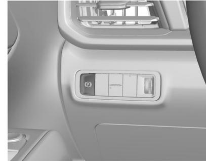
فرامل الركن الكهربائية (EPB) دائماً ما تكون قابلة للربط، حتى مع ضبط المركبة على وضع إيقاف التشغيل. إذا كانت الطاقة الكهربائية غير كافية فلن يمكنك ربط فرامل اليد الكهربائية أو تحريرها. لمنع استنزاف البطارية، تجنب الدورات المتكررة غير الضرورية لفرامل الركن الكهربائية (EPB).
