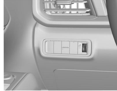
تعمل هذه الميزة على ضبط سطوع جميع عناصر التحكم المضاءة. يوجد مفتاح التحكم في إضاءة لوحة أجهزة القياسات بجوار مفتاح التحكم في المصابيح الخارجية.
