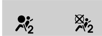
عند بدء تشغيل المركبة، يضيء مؤشر حالة الوسادة الهوائية للراكب الرموز التي تشير إلى التشغيل وإيقاف التشغيل، وذلك لعدة ثوانٍ كعملية فحص للنظام. ثم بعد عدة ثوانٍ، سيفوم مؤشر الحالة بإضاءة رمز التشغيل أو رمز إيقاف التشغيل لإعلامك بحالة الوسادة الهوائية الأمامية للراكب الأمامي الجالس على الطرف.
