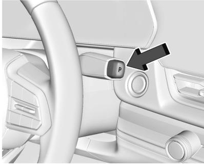
**P (ركن):** يُستخدم هذا الوضع في قفل العجلات القائدة. استخدم الوضع P (الركن) عند بدء تشغيل السيارة لضمان عدم تحرك السيارة. إذا كانت المركبة في وضع التشغيل، فيمكن تغيير المركبة إلى وضع P (الركن).
